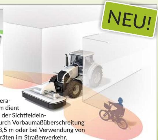
Das Querkamera-Monitorsystem dient zur Behebung der Sichtfeld-einschränkung durch Vorbaumaßüberschreitung von mehr als 3,5 m oder bei Verwendung von Frontanbaugeräten im Straßenverkehr.
